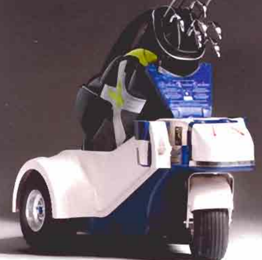
El carrito de golf automatizado Shadow Caddy sigue al jugador mediante un transmisor de radio.
