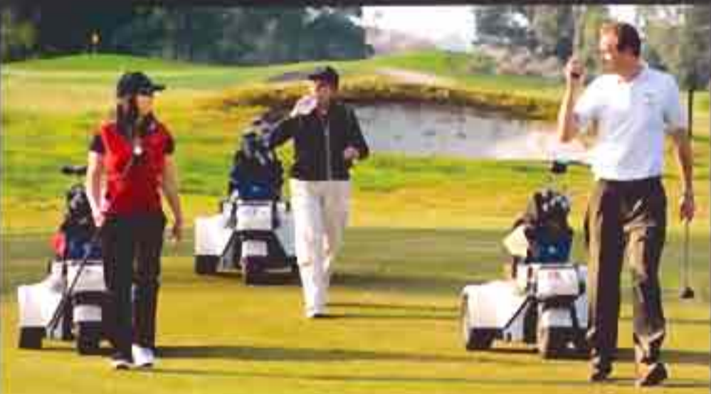
El carrito de golf automatizado Shadow Caddy sigue al jugador mediante un transmisor de radio.
